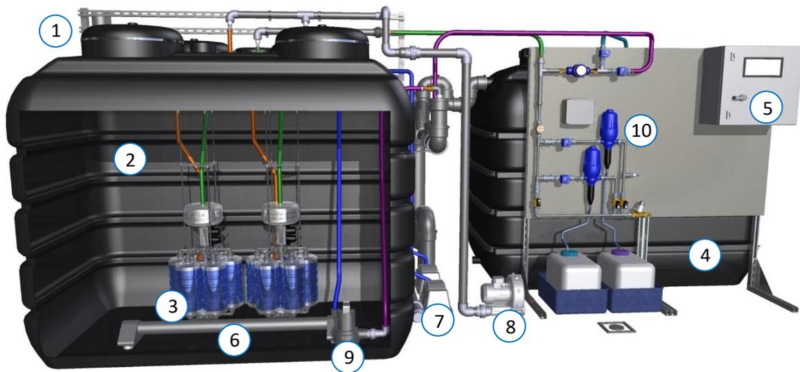
Abb 1: Überblick: AQUALOOP Vorkonfektioniertes Grauwasser-Recycling Komplettsystem 10800 l/Tag
