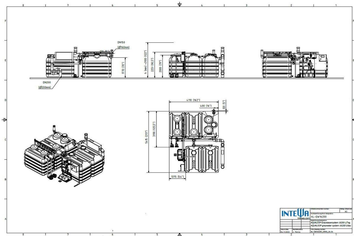
Abb. 2: Abmaße und Anschlüsse AQUALOOP AL-GW16200 I/d
