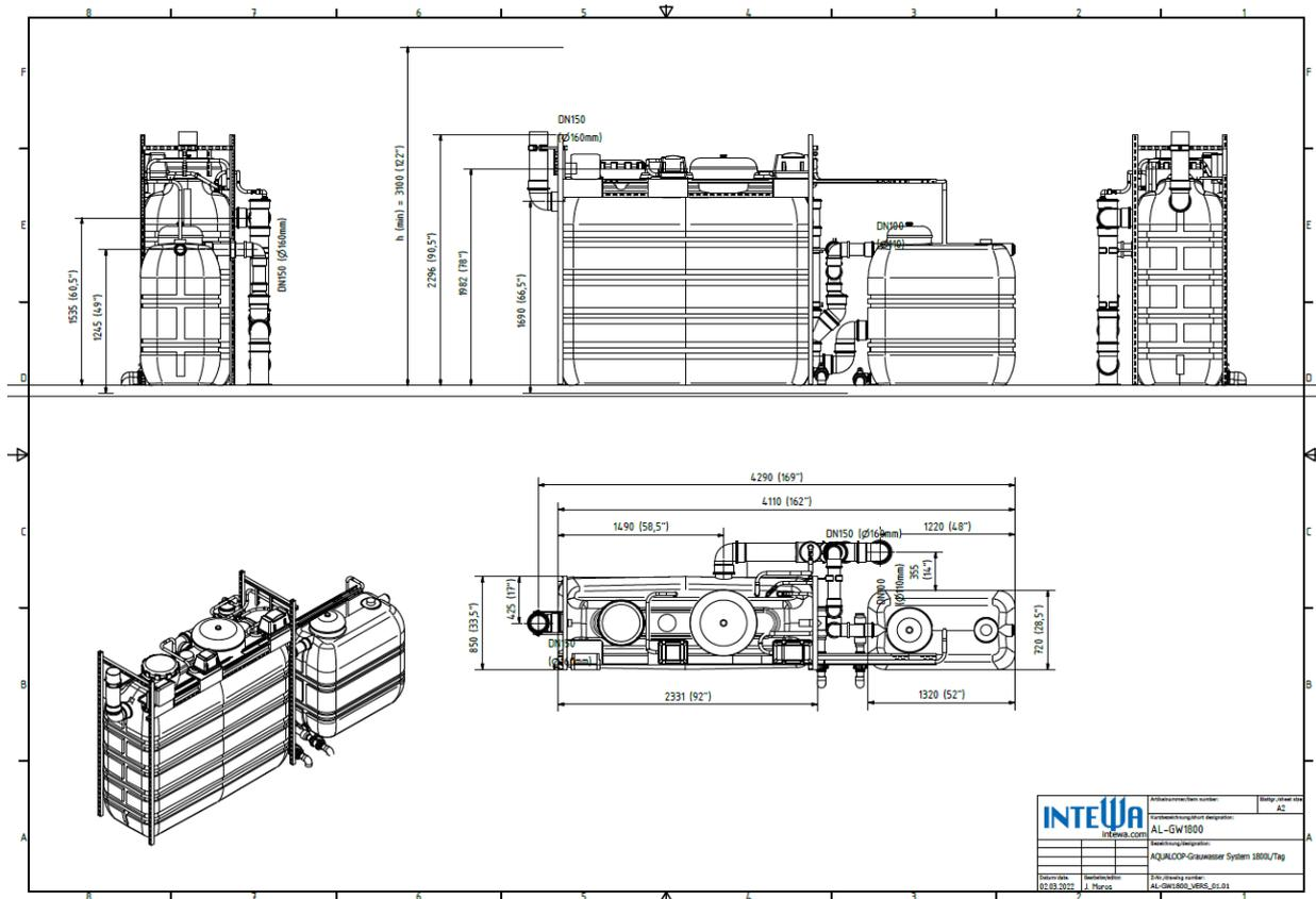
Abb. 2: Abmaße und Anschlüsse AQUALOOP AL-GW1800 I/d
