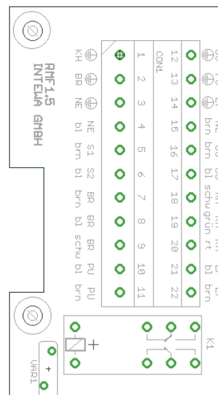
Klemmenblock der Basissteuerung im Klemmkasten
